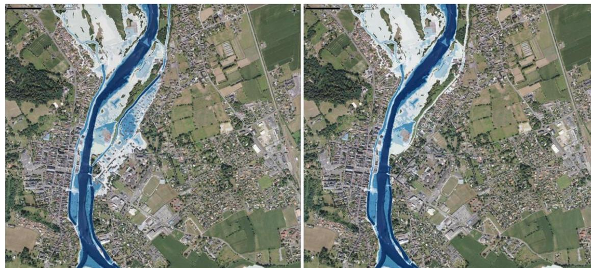
Figure 1 : Impact hydraulique du mur anti-crue à Nay
