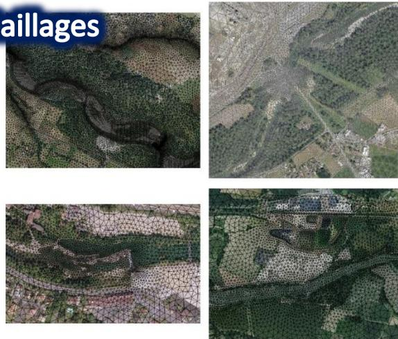
Figure 20 : Maillage du modèle hydraulique
