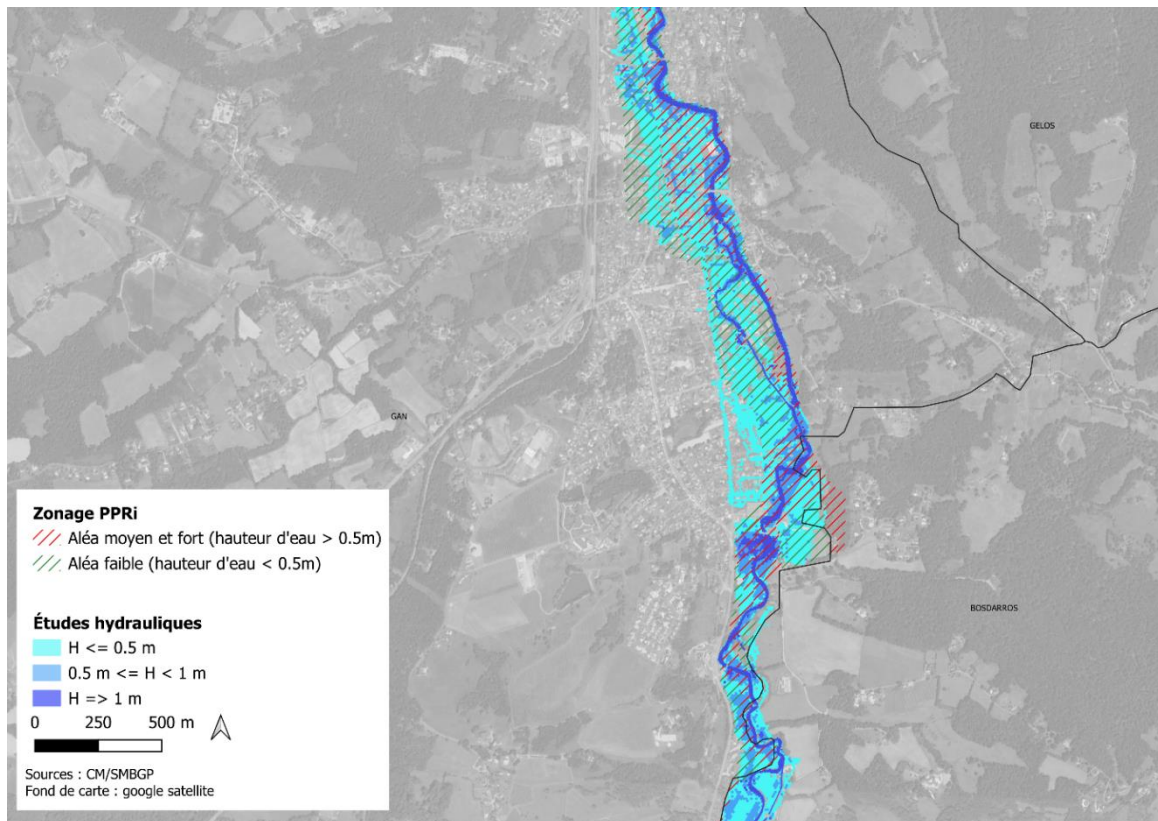
Figure 100 : Différences entre PPRI et études hydrauliques (Q100) sur le Neez au niveau de la commune de Gan
